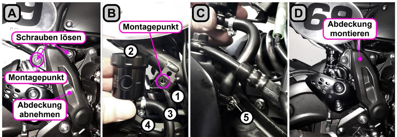
**A:** Die beiden Schrauben der Abdeckung lösen und die Abdeckung von oben zur Seite abziehen. Die Abdeckung ist im unteren Bereich mit einem Plastik-Clip befestigt, daher vorsichtig abziehen!
