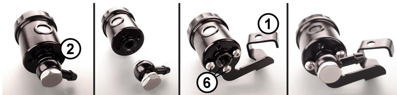
Den Halter (1) unter dem Ausgleichsbehälter (2) verschrauben.
