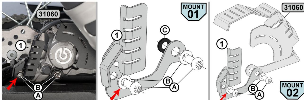
**(DE)** Beim hinteren Befestigungspunkt (▶) wird die Originalschraube ersetzt.
