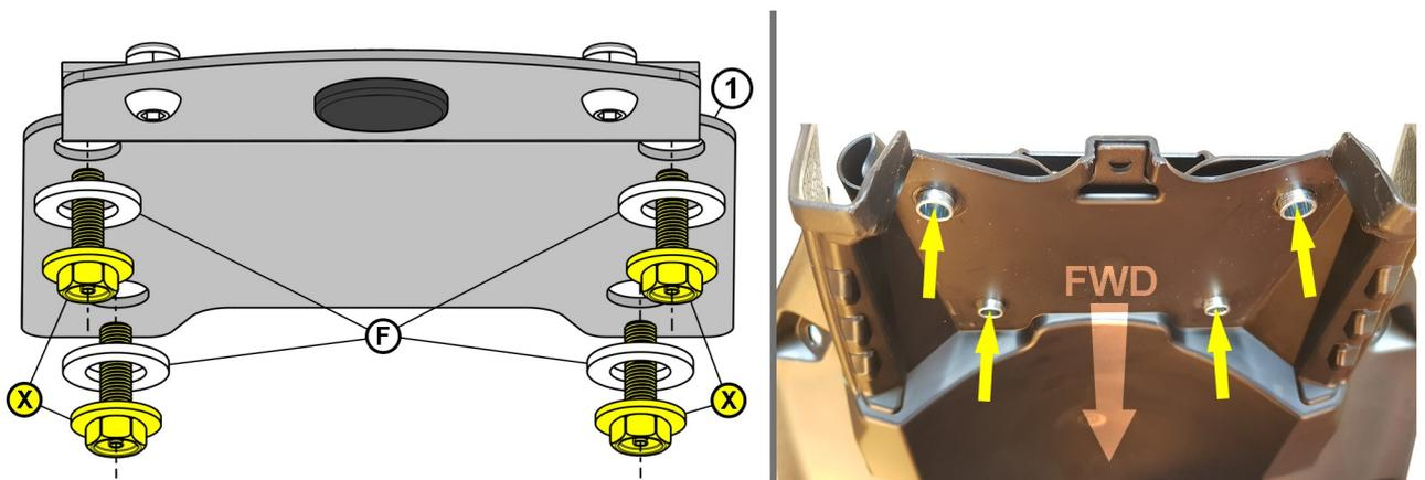
**DE** Die vorbereitete Grundplatte (1) von unten an seine Position unter dem Heck legen und mit den OEM-Schrauben (X) und den Scheiben (F) befestigen.
