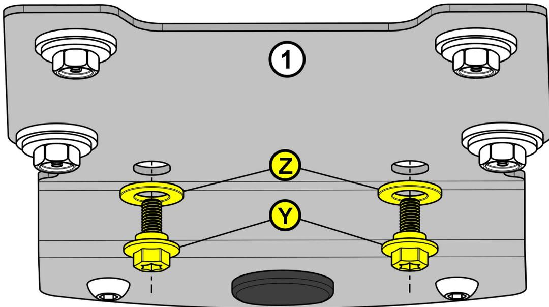
**DE** Das Rücklicht mit den originalen Befestigungselementen **(Y)** und **(Z)** von unten durch die Grundplatte **(1)** verschrauben.
