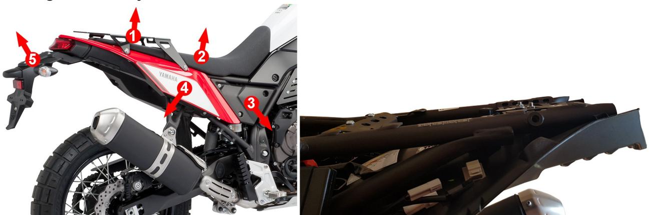
**(DE)** Gepäckträger **1**, Sitzbank **2**, Seitendeckel **3**, Heckverkleidung **4** und Kennzeichenträger **5** demontieren.
