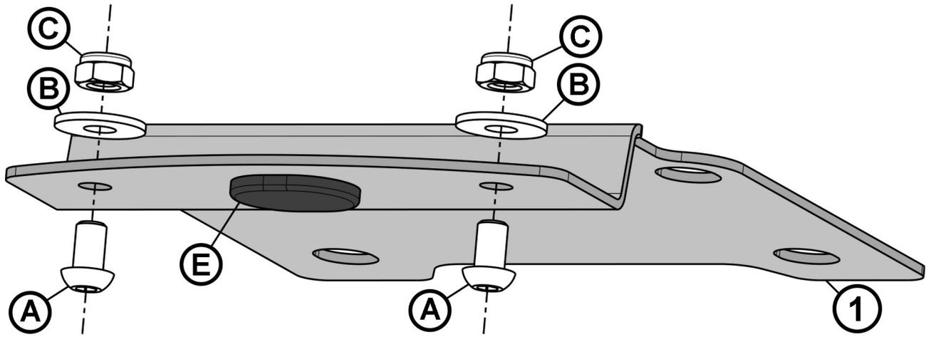
**DE** Die Grundplatte (1) mit der Gummiabdeckung (E) versehen und die Öffnungen im hinteren Teil der Grundplatte, wie gezeigt, durch Schrauben verschließen.
