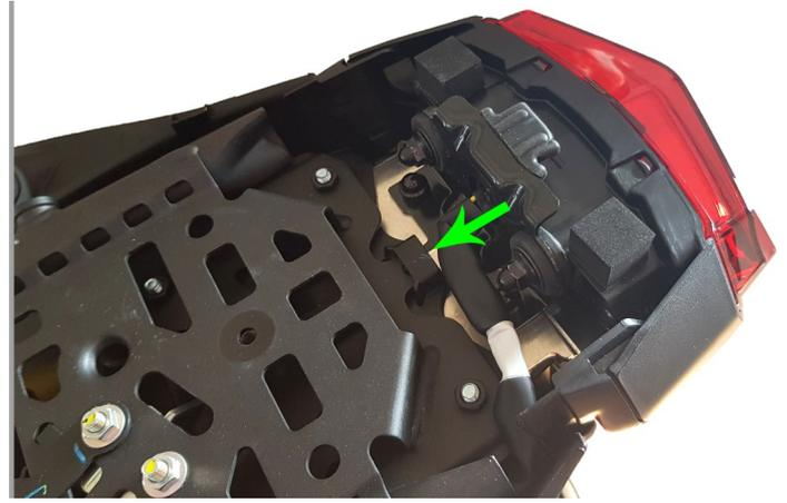
**DE** Das OEM-Rücklicht wird mit dem originalen Rücklichthalter von hinten über der Grundplatte **(1)** in seine Position geschoben. Hierbei ist darauf zu achten, dass die kleine Lasche in die dafür vorgesehene „Brücke“ gleitet.
