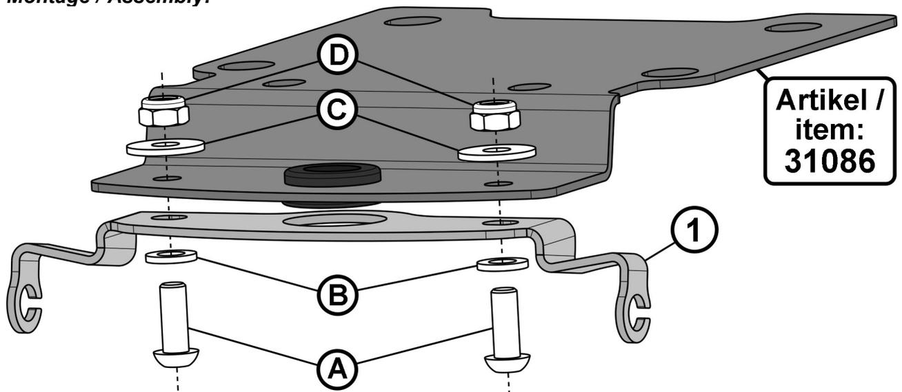
**(DE)** Der Blinkerhalter (1) wird, wie gezeigt, unter der Grundplatte des Artikels 31086 verschraubt. Die Blinkerkabel können durch die Kabeldurchführung geführt werden.
