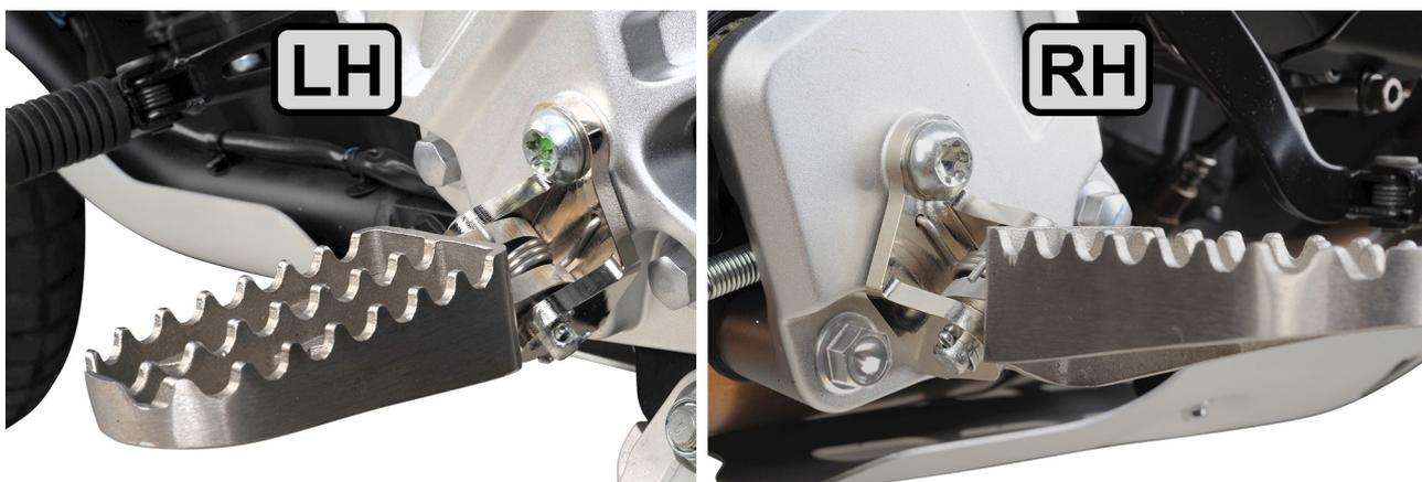
**(DE)** Die Position von Fußbrems- und Schalthebel müssen ggf. angepasst werden.
