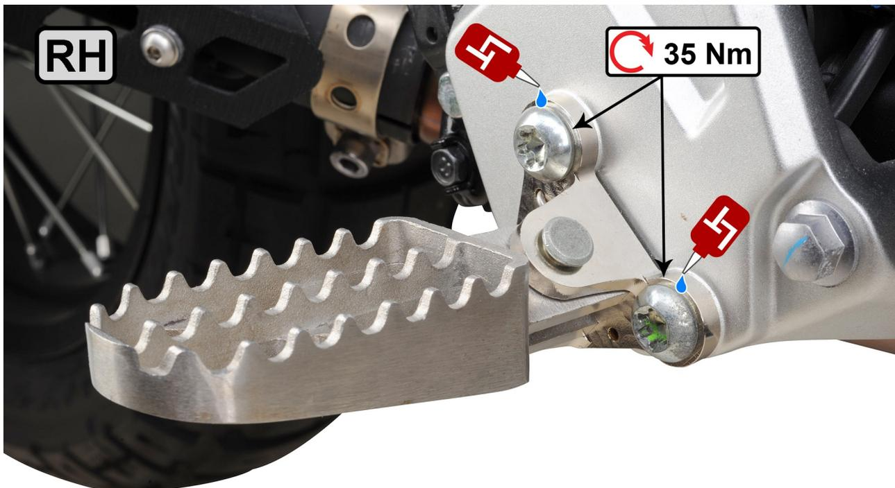
**(DE)** Die vorbereiteten Fußrastenhalter - wie gezeigt - mit den Originalschrauben montieren.
