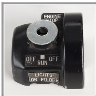
Jetzt kann das Gehäuse zur Verwendung des Replika-Killschalterknopfes umgebaut werden. Zur Führung des Bohrers beiliegende U8x24 Unterlegscheibe auflegen.
