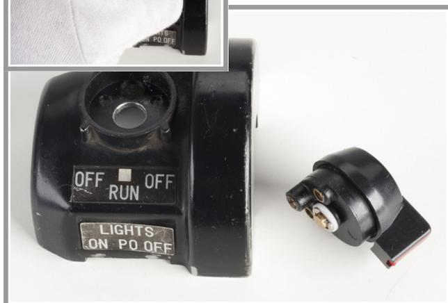
Dann wird die Schaltereinheit montiert. Hierzu zuerst die originale Kontaktplatte auf die Achse des Replika-Killschalterknopfes setzen. Dann folgen O-Ring, Kunststoffscheibe und abschließend der Clip.
