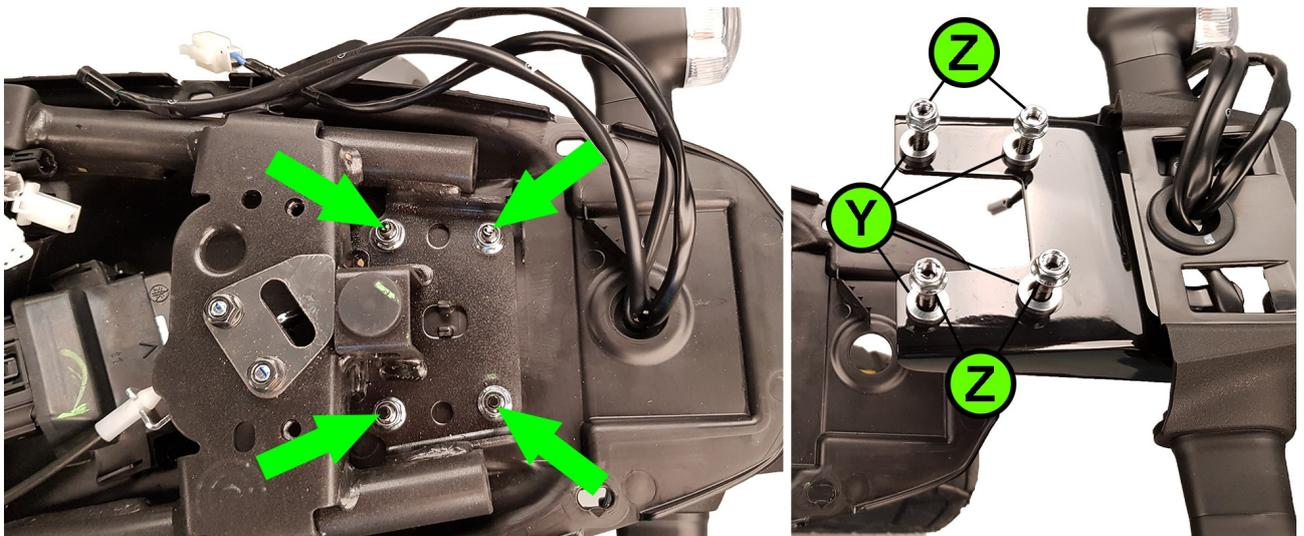
**(DE)** Die markierten Muttern (→) lösen und den OEM-Kennzeichenträger nach unten heraus ziehen. Die gelösten Muttern (Z) und die Distanzscheiben (Y) werden bei der Montage der KEDO-Heckabdeckung benötigt.
