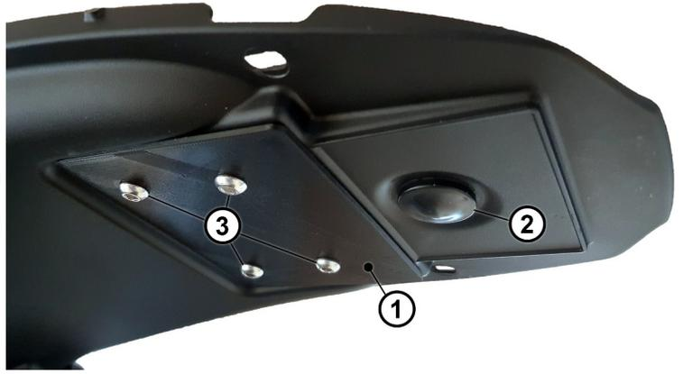
**DE** Die Abdeckplatte (1) wird – wie dargestellt - anstelle des OEM-Kennzeichenträgers montiert. Die Öffnung der Kabeldurchführung wird mit dem Blindstopfen (2) verschlossen und kann bei Bedarf (z.B. Blinkermontage mit dem LED-Blinkerhalter Artikel-Nr.: 60506) leicht eingeschnitten werden, um Kabel hindurch zu führen.
