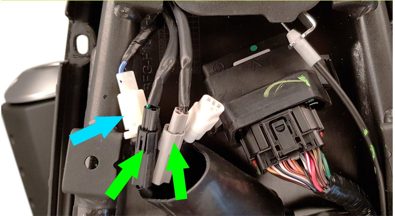
**(DE)** Die Steckverbindungen der Kennzeichenbeleuchtung (→) und der Blinker (→) lösen.
