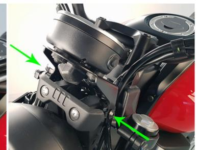
**(DE)** Den Tacho mit den originalen Unterlegscheiben und Schrauben (→) an den KEDO-Tachoversatz befestigen.
