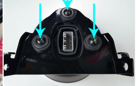
**(DE)** Die seitlichen Befestigungsschrauben (→) des OEM-Tachohalters lösen.
