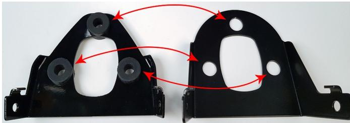
**(DE)** Die Gummidämpfer aus dem OEM-Tachohalter herausdrücken und in den KEDO-Tachoversatz einsetzen.
