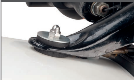
Gummidämpfer Rücklicht-Träger ergänzt die originalen Formgummis
